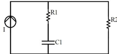
Figura 4. Esquemático de sólo una celda con su sistema de balanceo.
