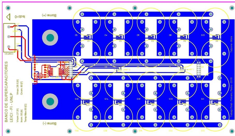
Figura 10. PCB del banco construido.
