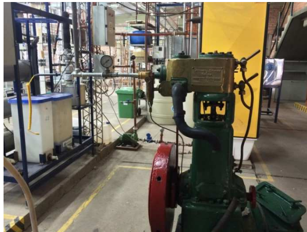
Figura 1: Motor a vapor ensayado en planta.
