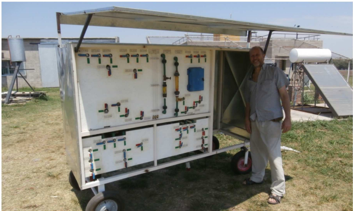
Figura 4: Máquina de ensayos múltiples de calentamiento de agua solar.
