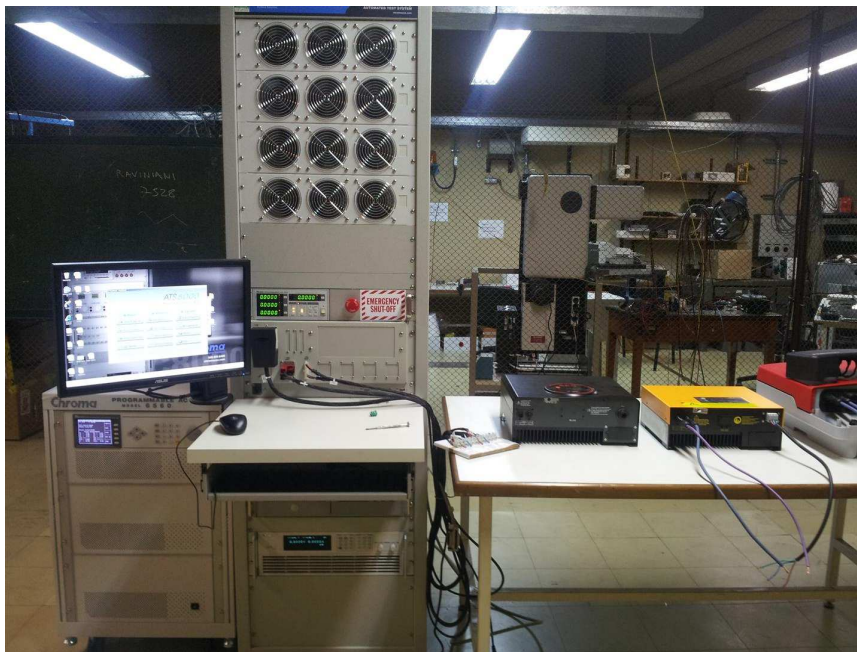
Figura 1: Sistema de mediciones de inversores ATS 8000 de Chroma
