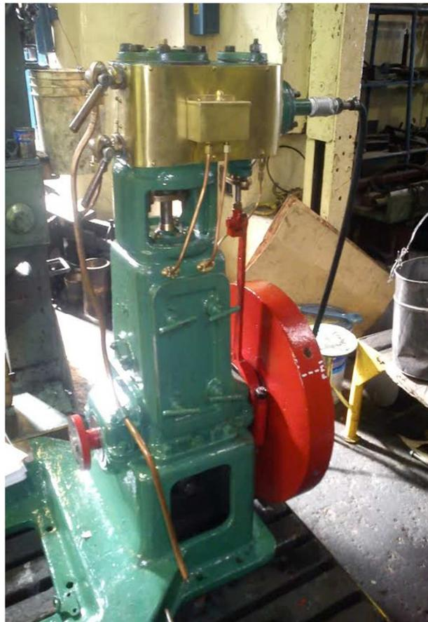
*Figura 1: Vista externa del motor de vapor recíprocante.*
