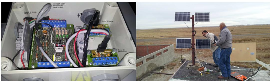
Figura 3: Modificación sistema de sensores para 2 canales I (ACS014-5), uno de V (2014) (izq), y montaje de paneles inferiores, canal IFV2 (der.)
