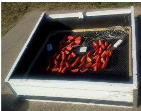
Figura 5: Secadero con tomates, termocuplas e indicadores de humedad (sin la tapa)
