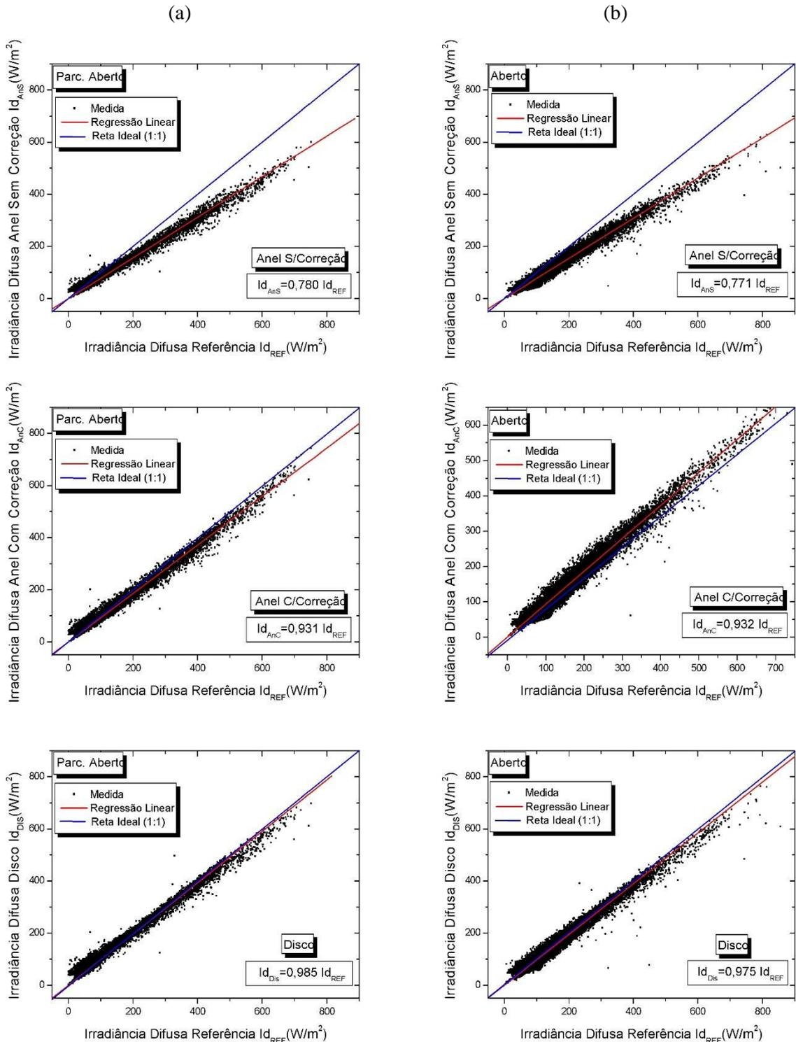
Figura 4. Comparação entre os métodos de medida do anel de sombreamento (sem e com correção geométrica) e disco em relação ao método de referência. a) Cobertura de céu parcialmente aberto; b) Cobertura de céu totalmente aberto.
