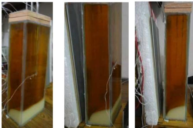
Figura 12. Visualización del frente de fusión en una sustancia orgánica con calentamiento lateral.
