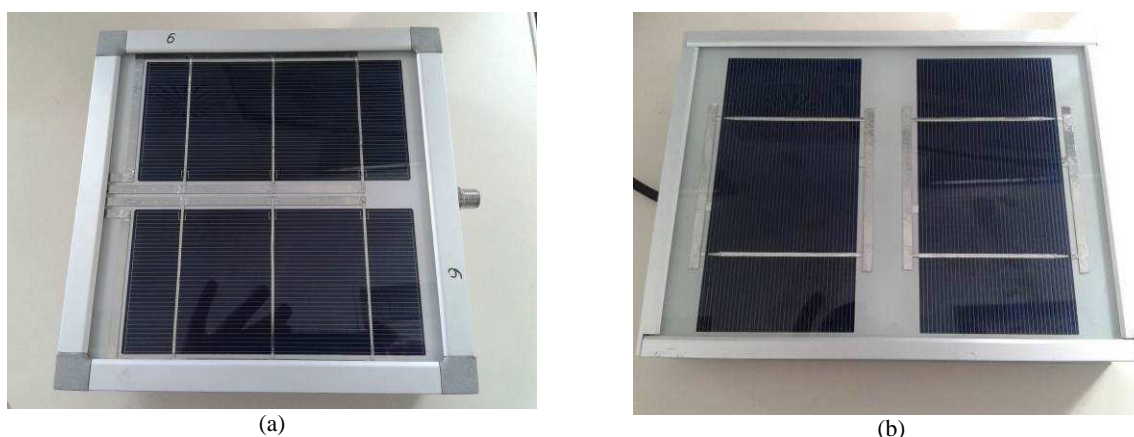
Figura 2: a) Fotografía de la celda patrón construida y calibrada por PV Evolution Labs . b) Fotografía de una celda a ser contrastada, desarrollada en el GER.
