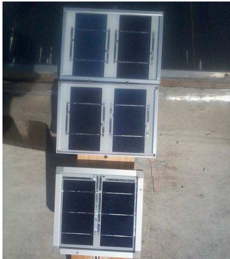
Figura 3: Disposición de la celda patrón con dos celdas a contrastar dispuestas sobre un mismo soporte, asegurando su coplanaridad.
