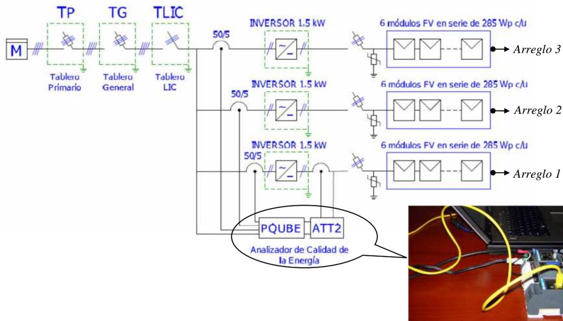
Figura 5: Esquema unifilar de la instalación FV realizada en la FI-UNMdP.
