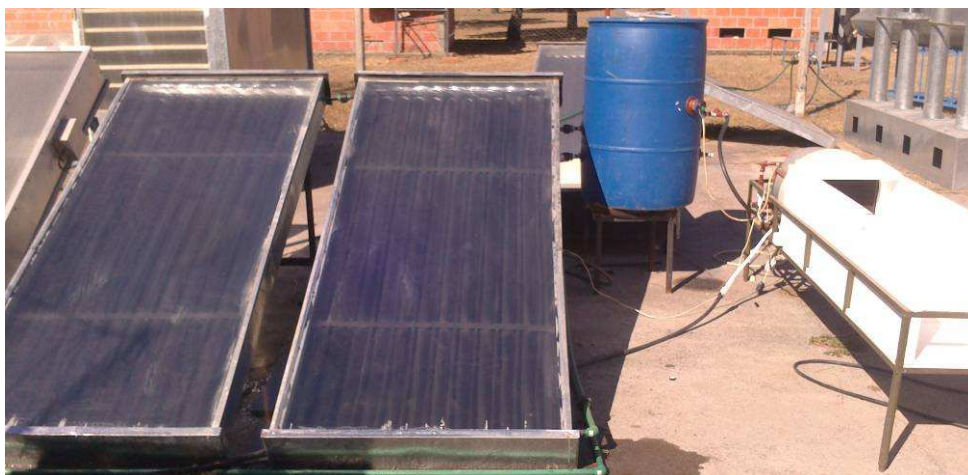
Fig. 2 – Fotografía del banco de colectores solares, tanque de almacenamiento, y cámara de secado.
