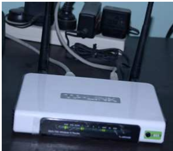
Figura 8: Enrutador WIFI utilizado como contenedor de una PC embebida.
