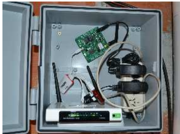
Figura 4: Vista del nodo de control, hub USB, y Pc embebida en su gabinete contenedor.
