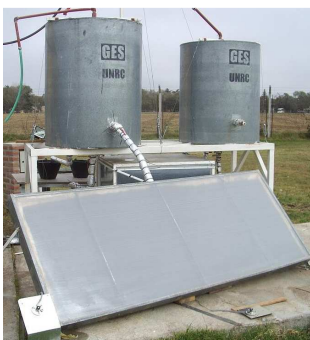
Figura 1: Sistema termosifónico en estudio.
