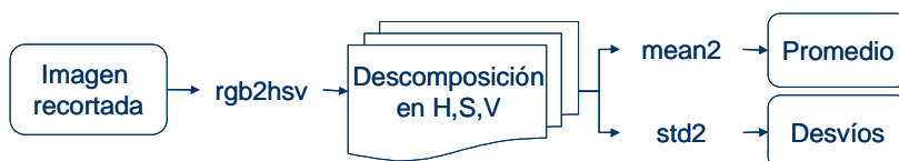
Figura 3 – Proceso de descomposición de imágenes en sistema HSV y análisis de cada canal.
