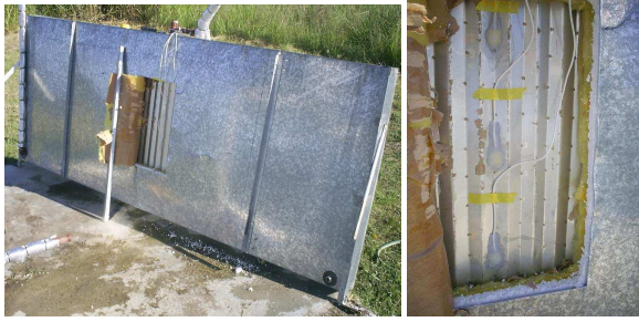
Figura 14: Termocuplas en el colector, a) parte trasera del colector, b) detalle de la colocación de termocuplas.
