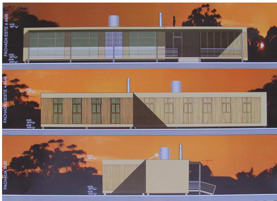
Figs. 7 y 8: Envolverte resuelta con tecnología de caña adaptada a diferentes orientaciones, generando fusión interior- exterior según la necesidad.
