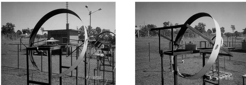
Figura 2: Anéis de Sombreamento com sensor quântico Li-Cor e piranometro Eppley PSP medindo as irradiâncias PAR-difusa ( $I_{pd}^{ex}$ ) e difusa ( $I_d^{ex}$ ).
