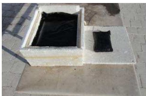
Figura 2. Bolsas selladas que contienen el material de cambio de fase, expuestas a la radiación.
