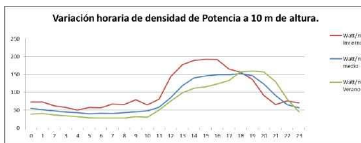
Figura 13. Variación horaria de la densidad de Potencia a 10 m de altura. Anemómetro del aeropuerto de la ciudad de Posadas.
