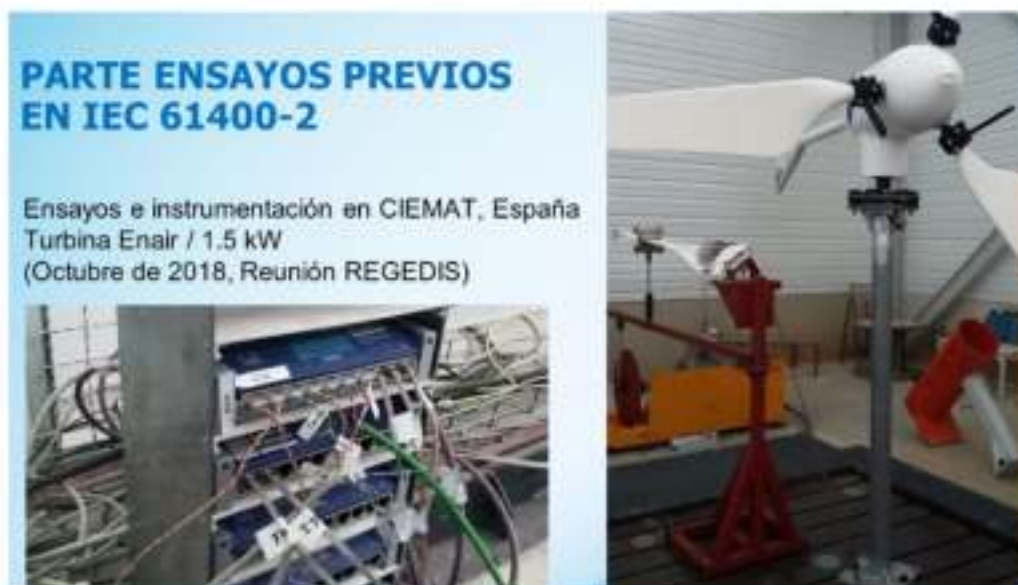
Figura 9: Ensayos de Esfuerzos en una máquina ENAIR, realizados en el CIEMAT / España (2018)
