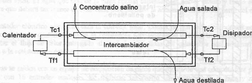
Fig. 1.- Esquema del principio de funcionamiento de un destilador en contracorriente
