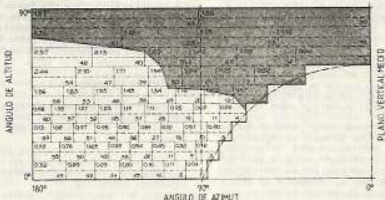
Fig. 13: "Cartilla de potencial" de enfriamiento radiante con enmascaramiento parcial según el ejemplo (Fig.11), para un radiador con pendiente de 60°, tomando como plano de referencia el del radiador.
