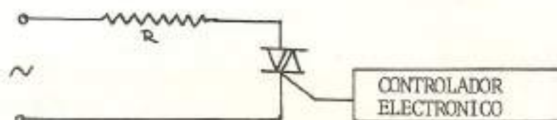
Fig. 5 - Conexión del sistema electrónico de control.
