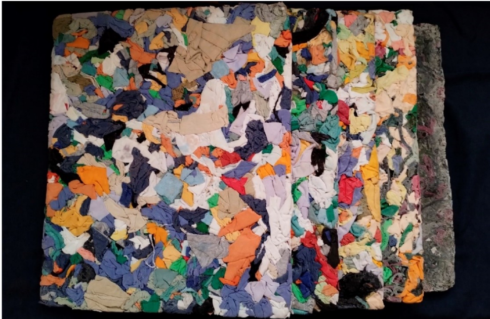
Figura 2: Placas aislantes de residuos textiles y almidón de papa.
