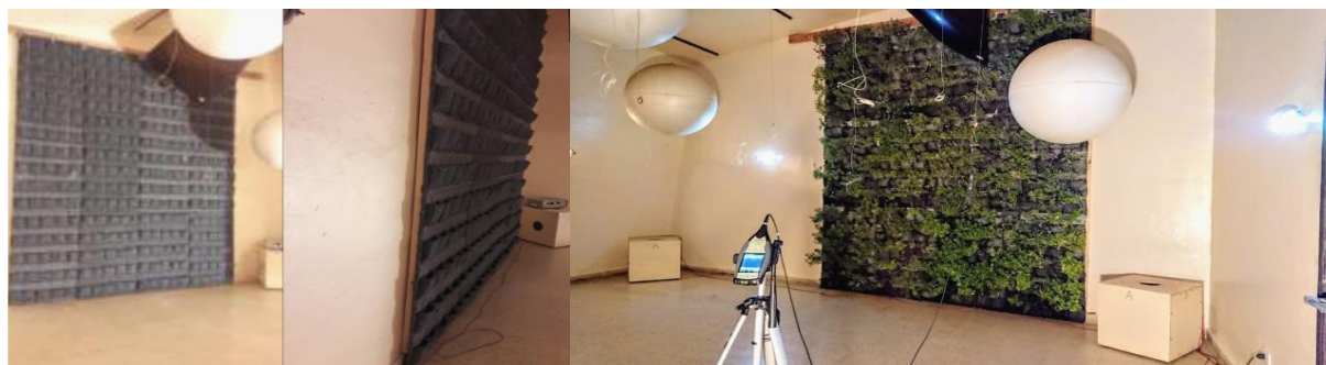
Figura 3. Presentación de la muestra en la cámara reverberante.
