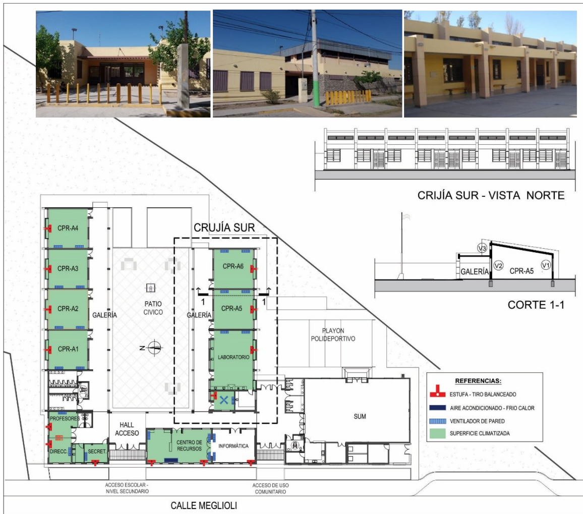
Figura 1: Planta del Colegio Provincial de Rivadavia con indicación de artefactos y espacios climatizados. Corte, vista y fotografías. Fuente: elaboración propia.
