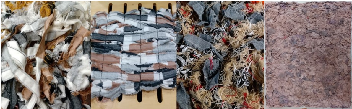
Figura 3. Proceso de manufactura desde la recepción del rollo de orillos y falsos orillos textiles hasta su corte, mezclado y fabricación de la placa TEXACEM ® . Referencia: elaboración propia.
