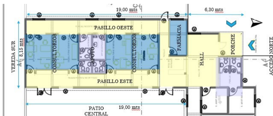
Figura 3: Planta Funcional área Salud
