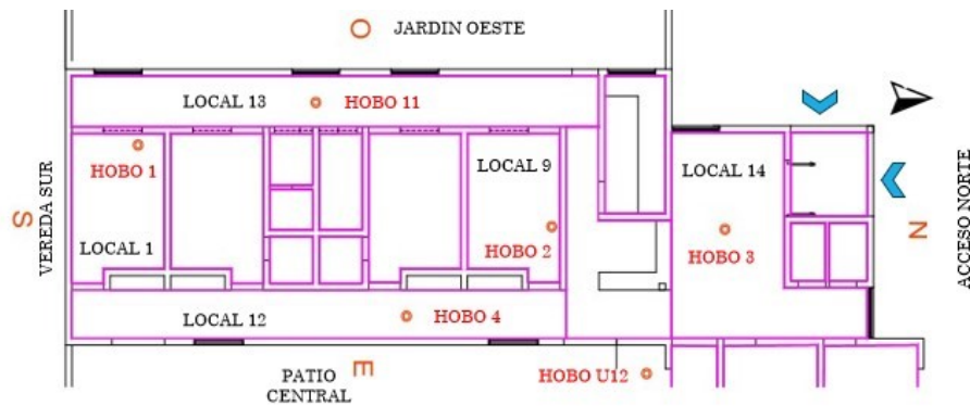
Figura 4: Planta ubicación sensores en locales área Salud
