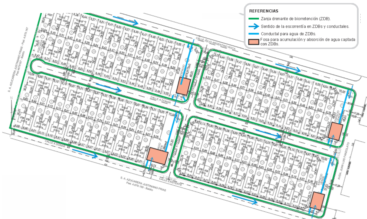
Figura 13: Plano del Barrio con el sistema de zanjas de biorretención, conductuales y fosas de infiltración. Fuente: elaboración propia.
