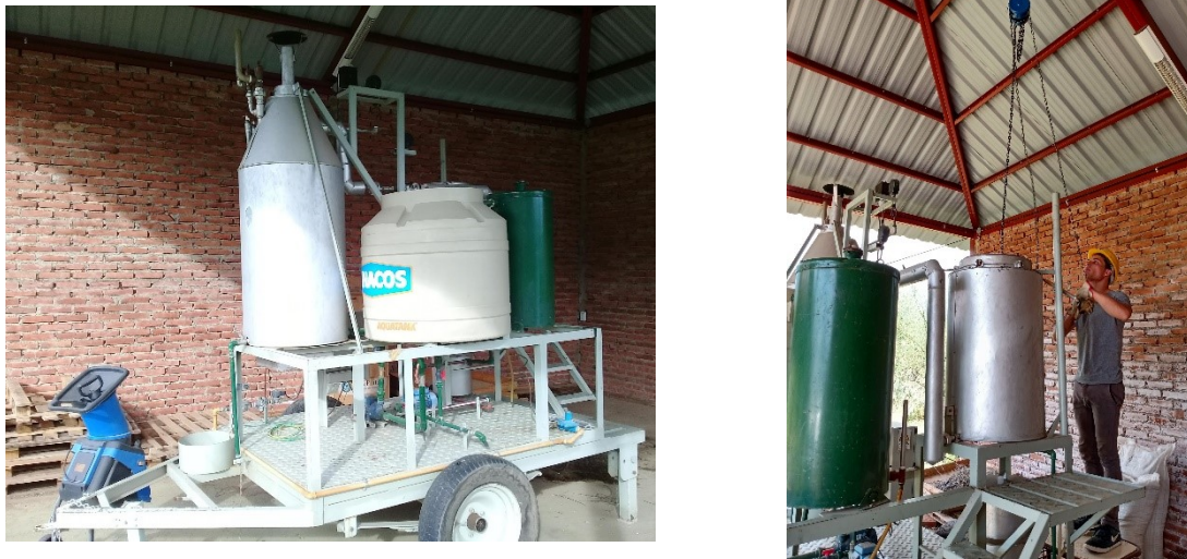
Figura 2: Planta de extracción de aceites PEM 100. Merlo, San Luis. Durante el ensayo de rendimiento
