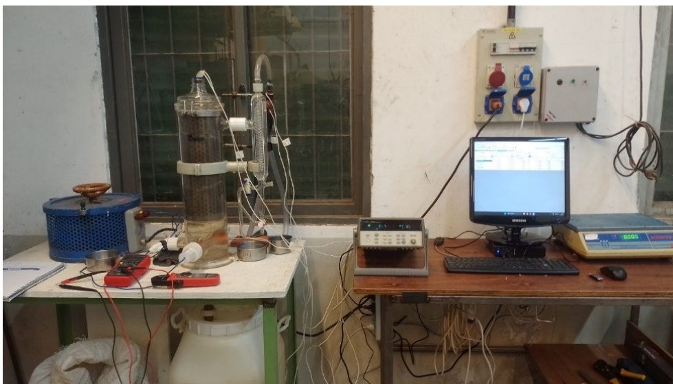
Figura 3: Destilador durante el ensayo
