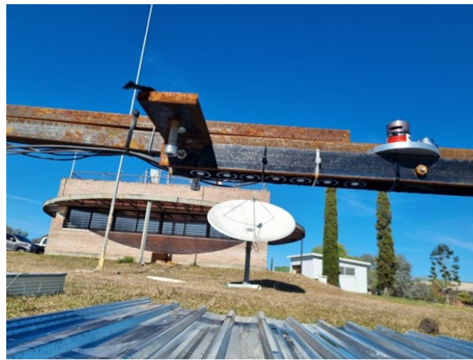
Figura 1: Arreglo experimental: siete LI-200 orientados hacia abajo, separados 3 cm y montados a 30 cm sobre la chapa; la línea de sensores cruza de cresta a cresta. Dos chapas de 1 m en continuidad aseguran que el campo de visión esté dominado por la propia superficie.
