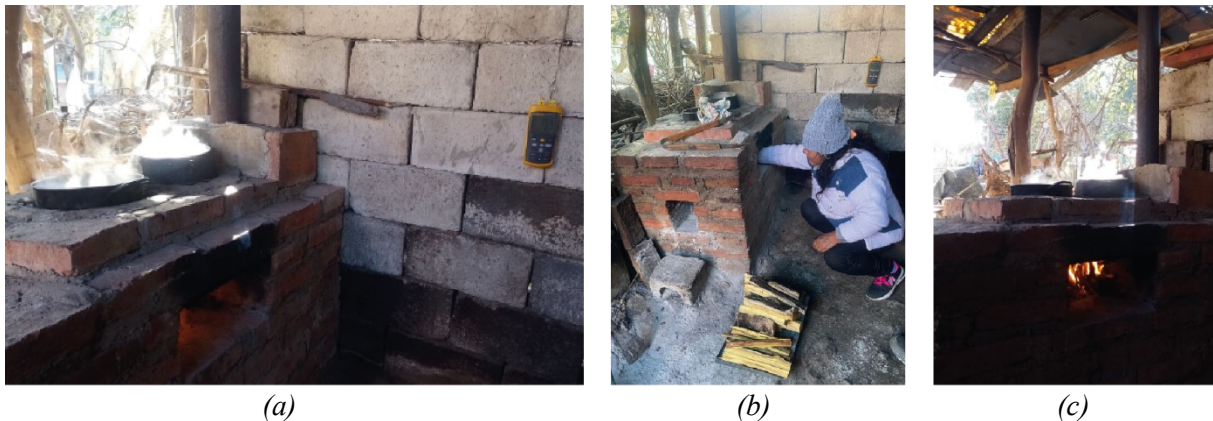
Figura 3: Ensayos en la Cocina Martina construida, (a) vista de frente, con medidor de temperatura del agua de las ollas, (b) vista general, junto con la propietaria y la leña utilizada, (c) vista general con fuego encendido.
