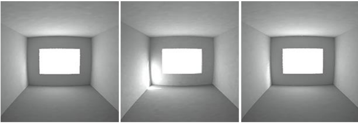
Fig. 10: Imágenes HDR de la caracterización con base BSDF, modelo glass y modelos trans, para un día típico (21/03) a las 10:00 am (Mendoza, Argentina).
