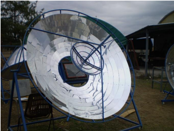
Fig. 1: Concentrador solar de Fresnel de doble reflexión
