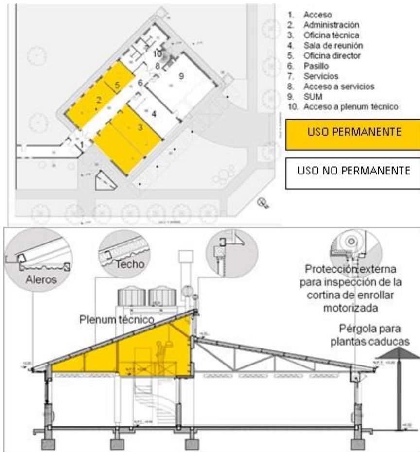
Fig. 2: Planta y corte del edificio.
