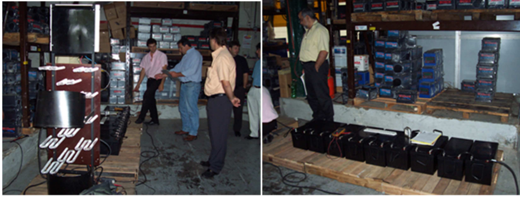
Fig. 6: Ensayos de baterías VISION 6FM200X en laboratorio del proveedor.
