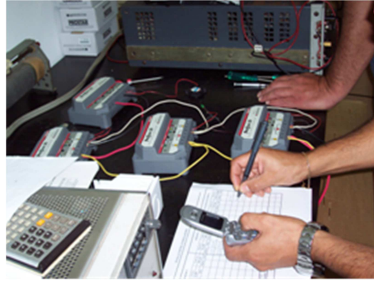
Fig. 4: Ensayos de reguladores MORNING- STAR PS30 en Laboratorio del GENOC.
