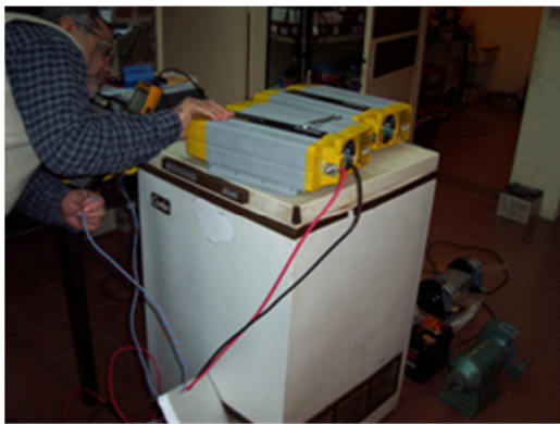
Fig. 3: Ensayos de los inversores XANTREX PROSINE 1000 i en laboratorio del GENOC.
