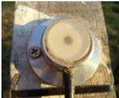
Fig. 3: Fotografía del sensor fotovoltaico CNEA
