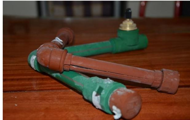
Fig. 15: Congelamiento a -15 °C, se observó la rotura del caño testigo, mientras permaneció intacto el de termofusión.
