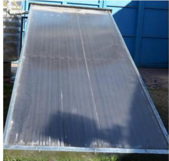
Fig. 3: Fotografía del colector con la cubierta de policarbonato.
