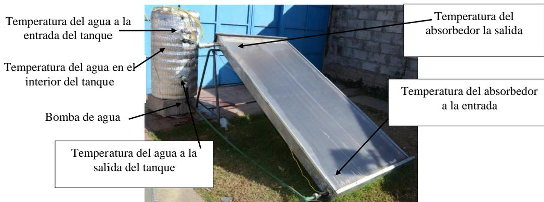
Fig. 5. Fotografía donde se muestra el sistema completo colector y el tanque de almacenamiento, también se indican la posición de las termocuplas..
