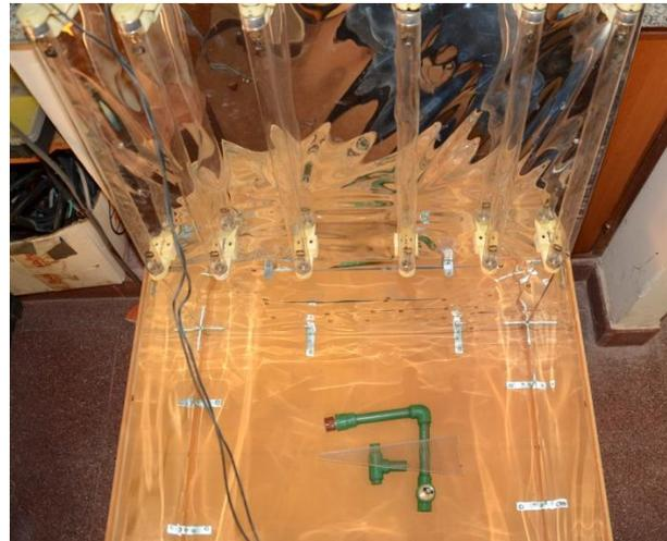
Fig. 16: Ensayo de envejecimiento del tubo con lámparas UV.
