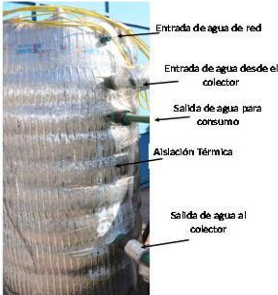
Fig. 2: Fotografía del tanque con 120 litros
