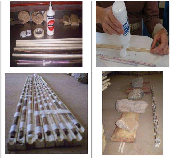
Fig. 3: Protocolo del montaje: pegado sobre portamuestras, ajuste con cinta y aplicación de presión.
