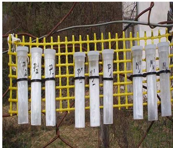
Fig. 1: Juego de muestreadores por triplicado para  $\text{NO}_2$ ,  $\text{SO}_2$  y  $\text{O}_3$
