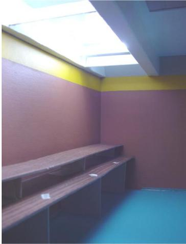
Fig. 15: Apariencia del espacio con Sistema de iluminación Natural, 21 de Septiembre. Modelo a escala con difusores.
