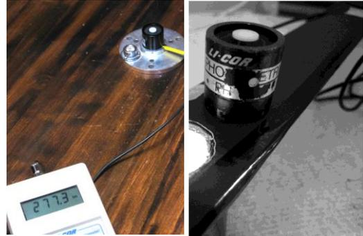
Fig. 4 y 5: Radiómetro marca LI-COR 189, con sensor fotométrico LI-210 SB.
