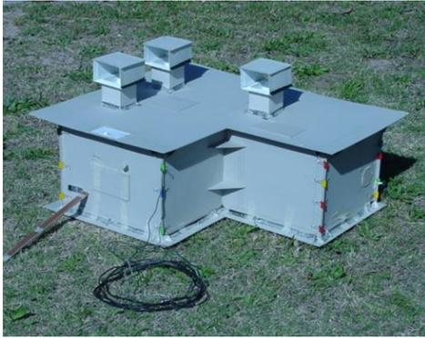
Fig. 7: Modelo a escala del espacio analizado vista exterior, reproducción de la configuración de los lucernarios.
