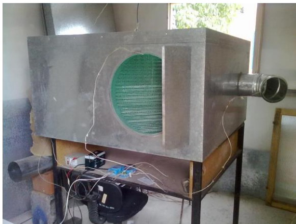
Fig. 3: Foto del intercambiador con el instrumental empleado para su ensayo.
