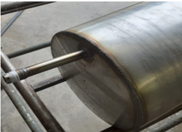
Fig. 4: Tanque interno A para agua caliente sanitaria, con tapas de mayor espesor y menor diámetro, sometido a presión de ensayo de 4,5 atm.
