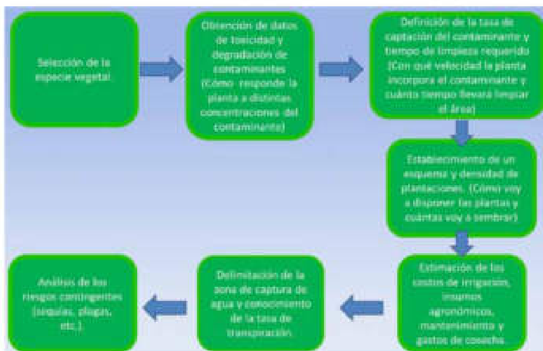
Figura 2. Pasos a seguir y tener en cuenta a la hora de plantar un esquema de fitoremediación.
