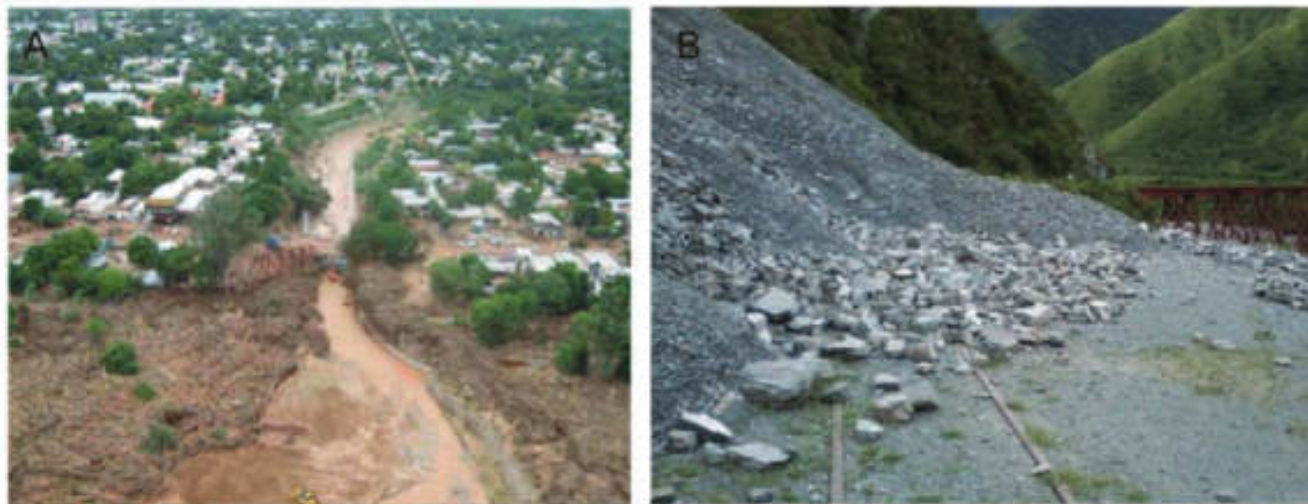
Figura 9: A- Vista área del río Tartagal después del alud de Febrero de 2009 (Foto: Baumann et al. 2009); B- vista de las vías en la quebrada del Toro cortadas por un flujo de detritos (Foto: www.periovista.com.ar ).
