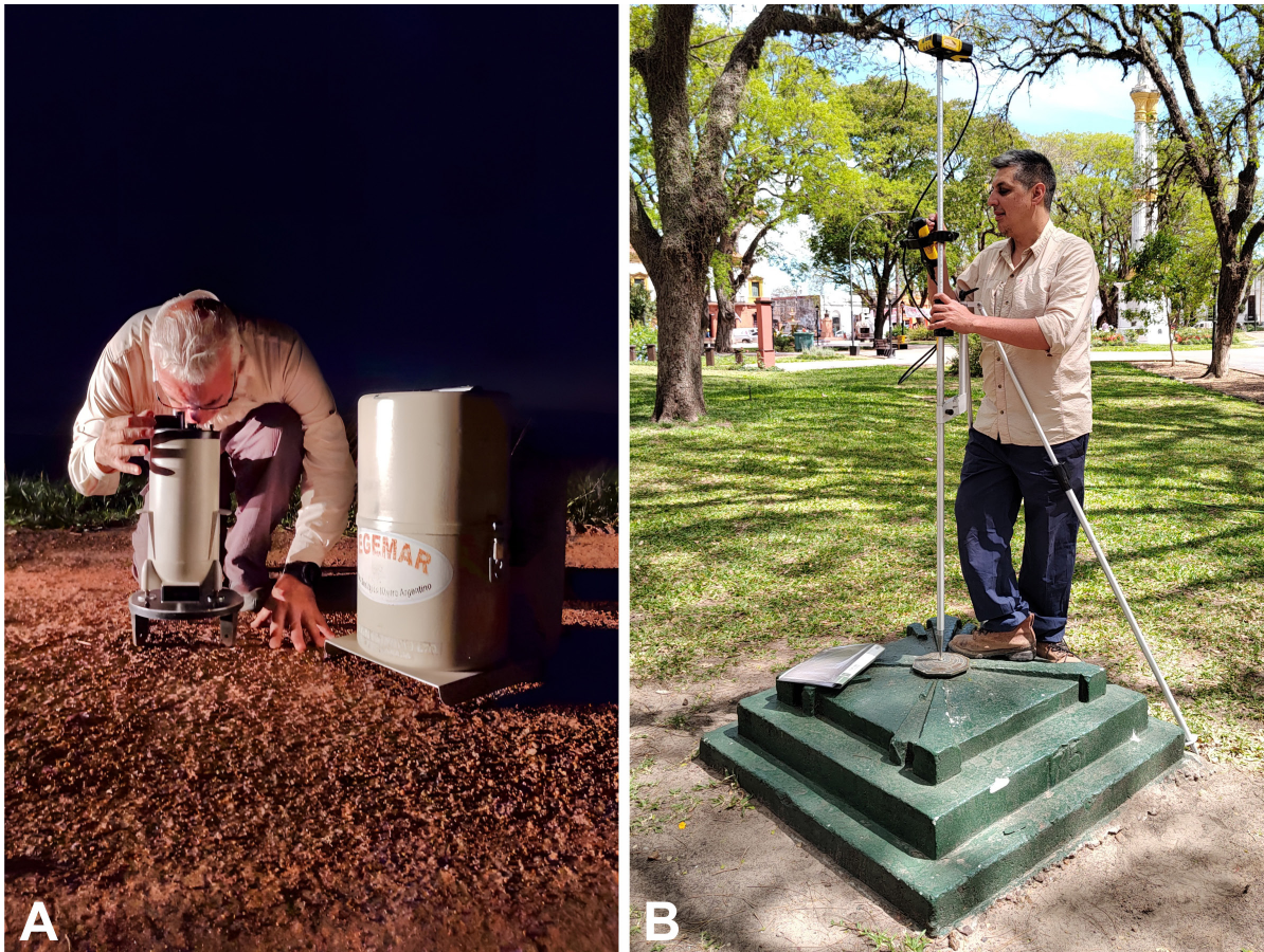
Figura 1. A: Gravímetro marca SODIN 200T con precisión de 0,01 mGal, perteneciente al SEGEMAR. B: Punto nodal Mercedes, Corrientes con gravedad conocida.
